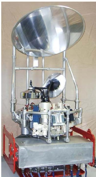
Рис.8. Сканер/зондировщик MTVZA-ГЯ [21].
