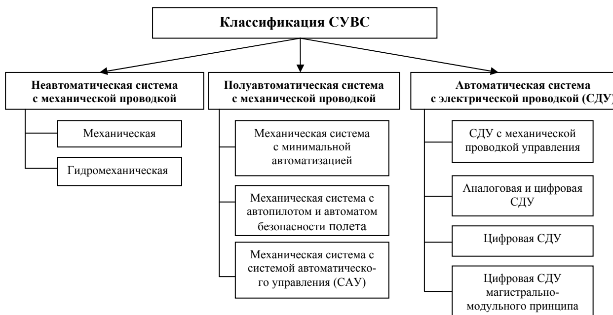
Рис. 1. Классификация СУВС по принципу действия и конструктивному исполнению
