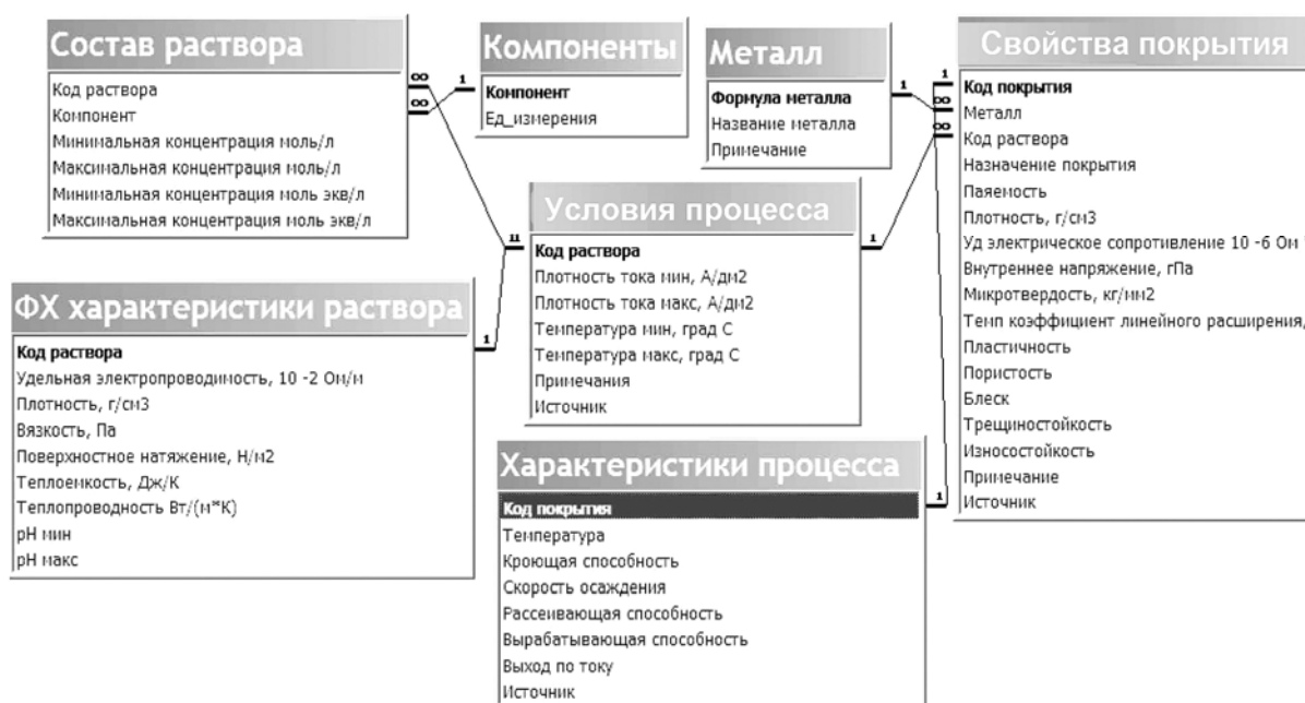
Рис. 1. Инфологическая модель ИС по составам растворов для электроосаждения металлов
