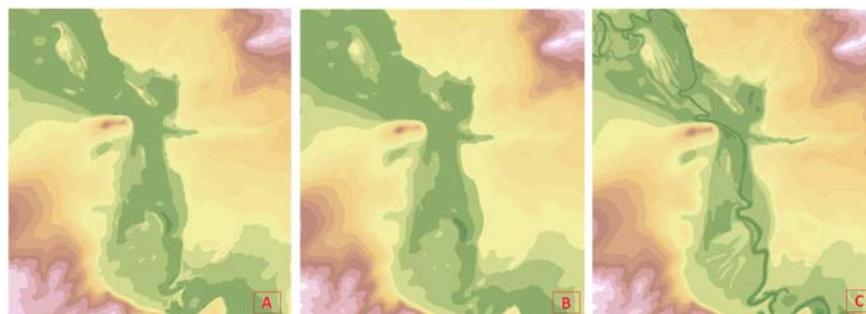
Рис. 14 – Сравнение GRID, интерполированных методом: А – Сплайн; В – ОВП; С – Topogrid
