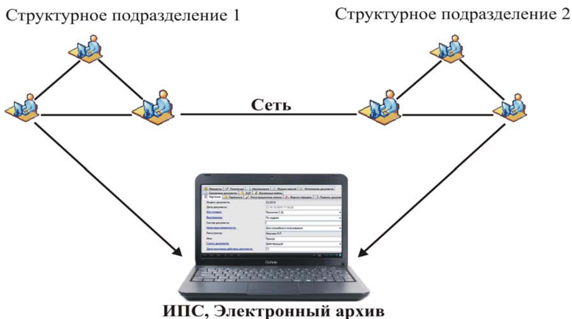
Рис. 2 Схема взаимодействия структурных подразделений организации в условиях системы автоматизации делопроизводства (САД)
