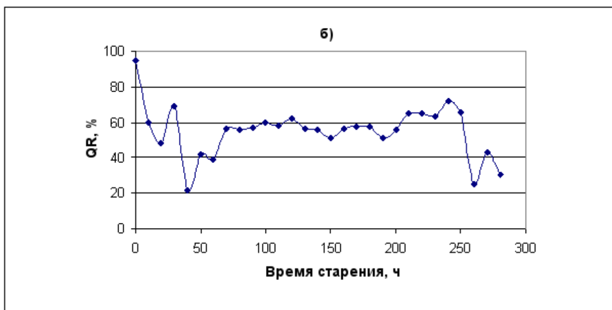
Рис.5. Изменение индекса качества QR дисков в процессе светового старения: а) при тестировании по программе DVD InfoPro 4.59 б) при тестировании по программе Nero CD-DVD Speed 4.51
