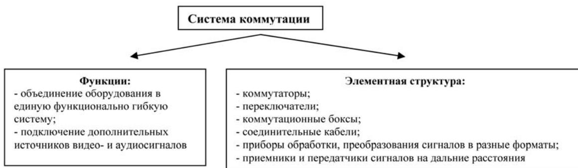
Рис. 5. Функционально-элементная структура системы коммутации конференц-зала
