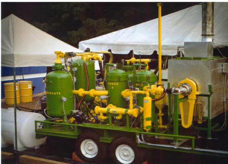
Рис. 9 . Вакуумная вращающаяся реторта, смонтированная на прицепе.
