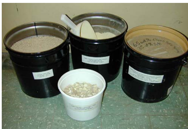
Рис.12 . Объемное сравнение компонентов шихты (три емкости слева) и конечного продукта (одна емкость справа) [42].
