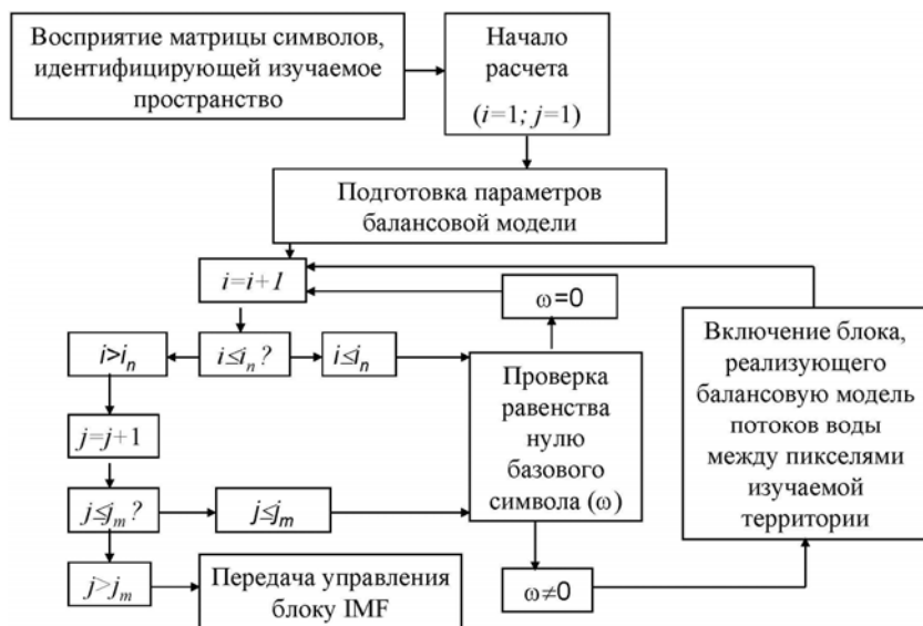
Рис. 5. Блок схема блока ИГП базовой программы МИМСГЭ, обеспечивающего управление процедурой расчета потоков воды между пикселями территории в соответствии с балансовыми уравнениями.
