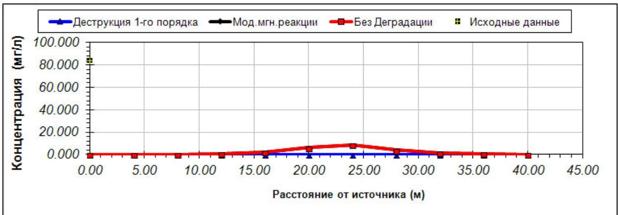
Рис. 8 – Прогнозные расчеты миграции нефтепродуктов через зону аэрации в шурфе 2
