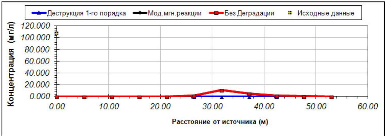
Рис. 6 – Прогнозные расчеты миграции нефтепродуктов через зону аэрации в шурфе 1
