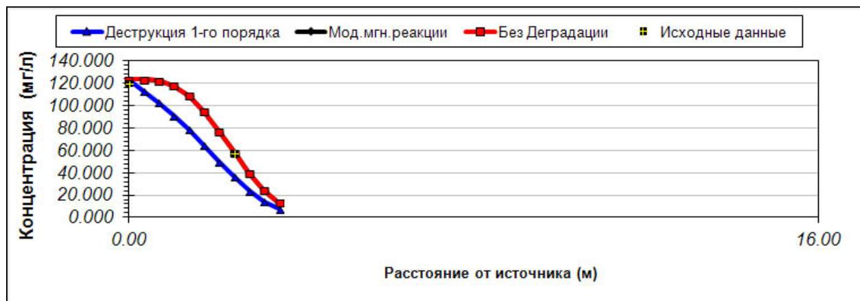
Рис. 4 – График распределения нефтепродуктов в зоне аэрации
