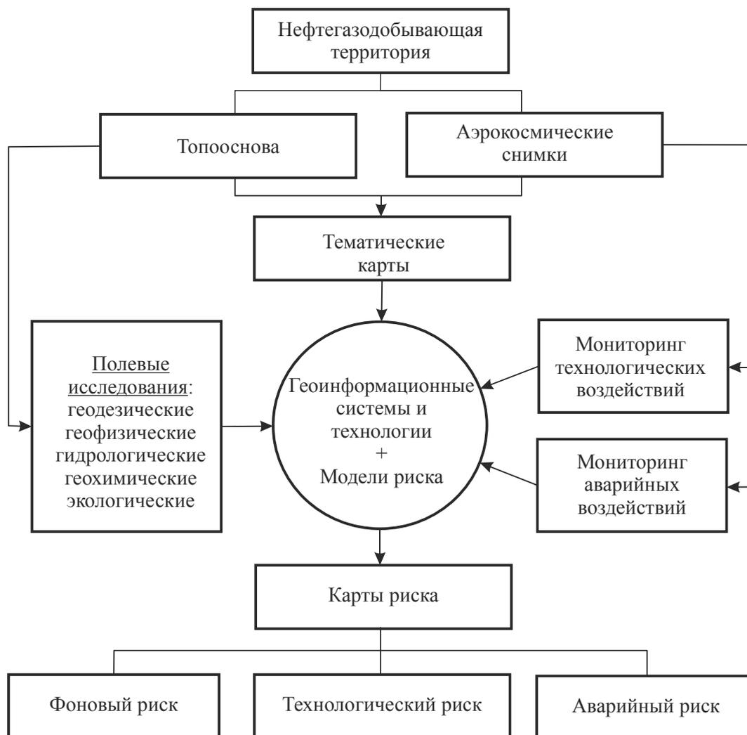
Рис. 1 – Схема анализа и разработки карт риска
