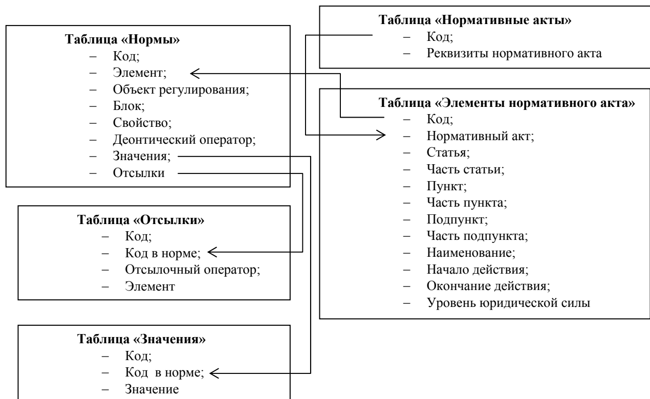
Рис. 1. Структура базы данных для хранения формализованной записи нормативных актов
