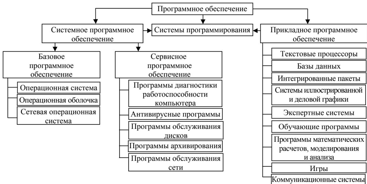
Рис. 3. Структура программного обеспечения
